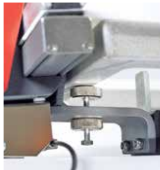
Schraube zur Anpassung an die Rahmenprofilhöhe – SEFAR® 3A
