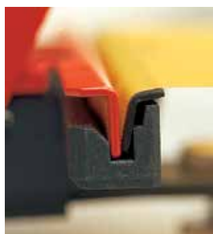
Progressiver Klemmbackendruck – SEFAR® 2
