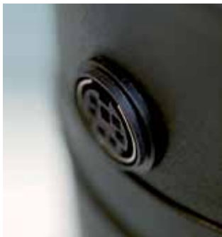
Serielle Schnittstelle RS 232 des SEFAR® Tensochek 100i
