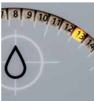
SEFAR® Humicheck – dreifarbige LED-Anzeige
