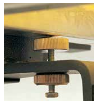
Schraube zur Anpassung an die Rahmenprofilhöhe – SEFAR® 2
